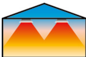
Mit Schwank Infrarotheizung bleibt die Wärme da, wo sie gebraucht wird: Auf dem Spielfeld.
