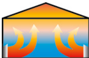
Mit konventionellen Heizungen steigt die Wärme nach oben.
