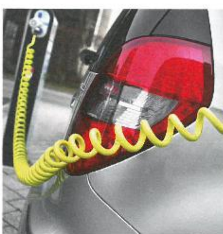
Wohntemperte Ladekabel Ohne Kühlung würden schnelle Ladevorgänge Lithium-Ionen-Batterien nach zwei Jahren ruinieren. Deshalb bringt Technotrans gekühlte Kabelverbindungen in den Markt
